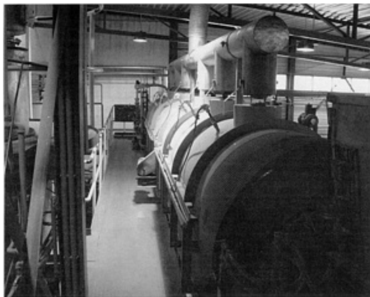
Fig. 4 Rotary furnace. Courtesy: Wolfram Bergbau- und Huetten-GmbH Nfg KG, Austria
