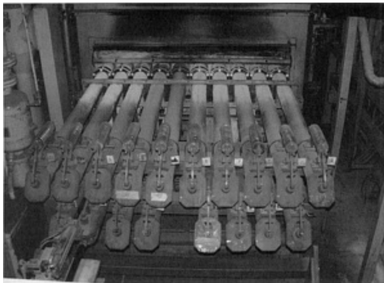
Fig. 3 Multitube push type furnace. Courtesy of Wolfram Bergbau- und Huetten-GmbH Nfg KG, Austria
